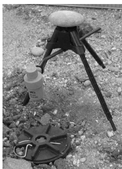
شکل ۱۴- سیستم SM-EOD ۲۰ گرمی در مقابل مین ضد نفر SPM-1 [۶].
