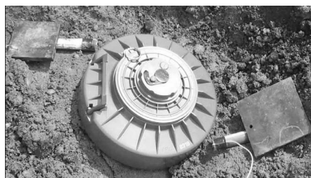
شکل ۷- شعله‌ی تیوکول در مقابل مین ضد تانک TMRP-6 [۶].
