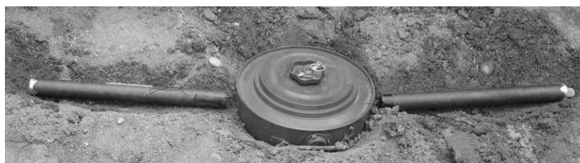
شکل ۶- مشعل آتش‌زا در مقابل مین ضد تانک TM-46 [۶].
