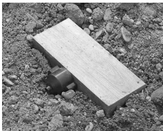
شکل ۱۳- سوراخ کننده PESCO (با ۱۱ گرم RDX) در مقابل مین ضد نفر PMD-6 [۶].
