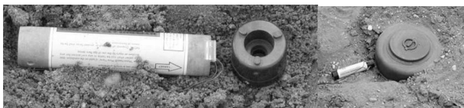
شکل ۳- شعله ی فوق گرم در مقابل مین ضد نفر T-AB-1 و مین ضد تانک گرد [۶].
