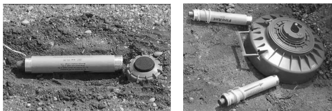
شکل ۲- سیستم پیروتکنیکی مورچه آتشین در مقابل مین ضد نفر VS-50 و مین ضد تانک TMRP-6 [۶].
