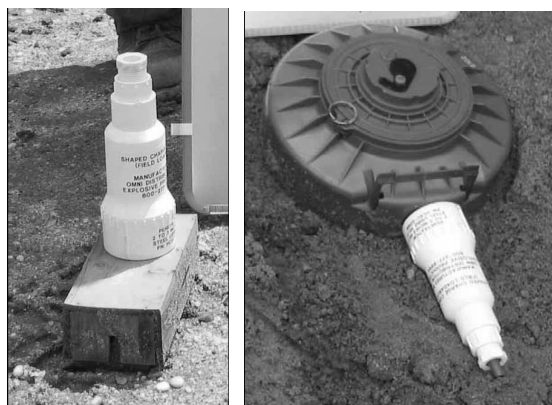
شکل ۹- سیستم هلیکس در مقابل مین ضد نفر PMD-6 و مین ضد تانک TMRP-6 [۶].
