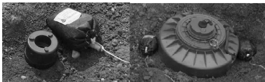
شکل ۵- کیسه‌ی آتش‌زا در مقابل مین ضد نفر T-AB-1 و مین ضد تانک TMRP-6 [۶].
